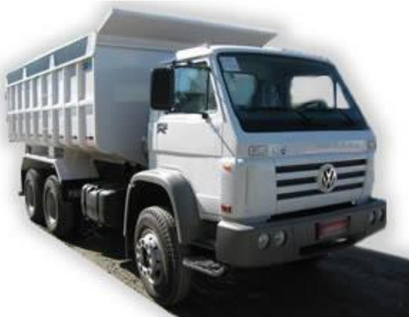
(Imagem 001: exemplo de caminhão basculante 12m<sup>3</sup>)
