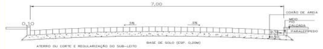
DETALHE SEÇÃO TRANSVERSAL DA PAVIMENTAÇÃO ESCALA: 1/100
