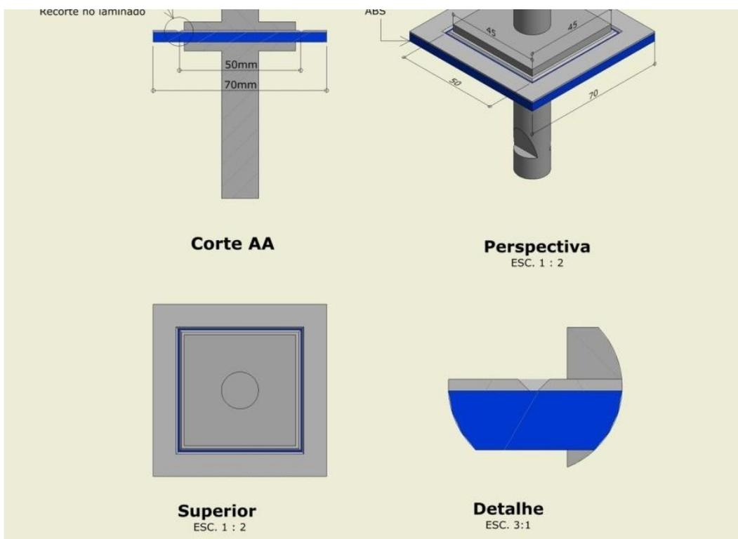
**Ilustração 1 – corpo de prova e dispositivos de tração**
