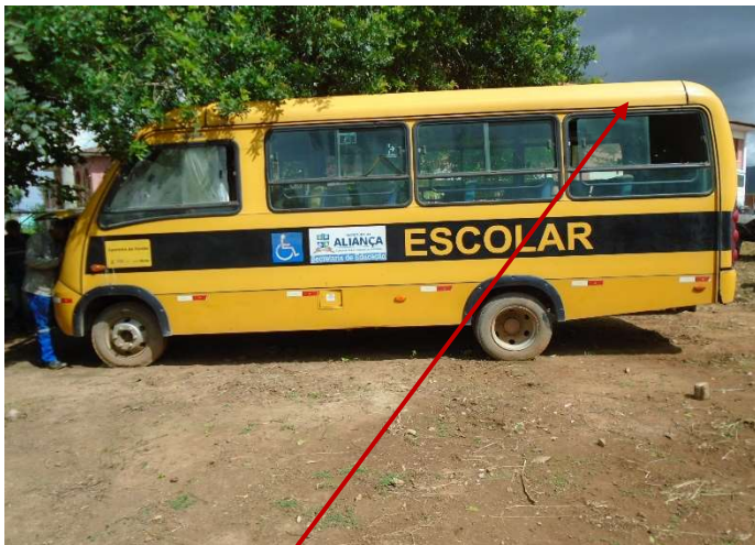
FOTO 01 – Teto desbotado precisando de repintura
