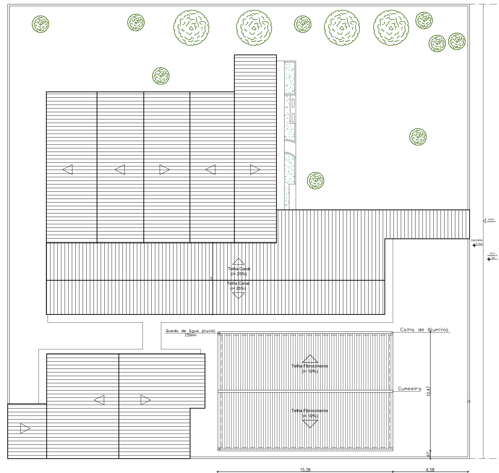
05 Planta de Coberta - Implantação ESC 1:150
